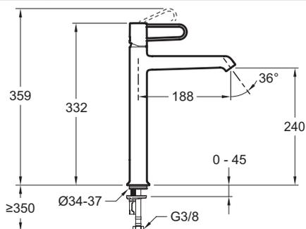
Спецификация продукта : Смеситель для раковины без донного клапана. E21031-CP. Коллекция : ODEON RIVE GAUCHE. ВЕС : 1.7 кг. МАТЕРИАЛ : N/A. ТИП УСТАНОВКИ : 1 отверстие. TYPE : Однорычажный. DÉBIT (L/MN SOUS 3 BARS) : 5л/мин. SAILLIE DU BEC (MM) : 188. RACCORDS : С гибкой подводкой. MÉCANISME : Керамический картридж.
